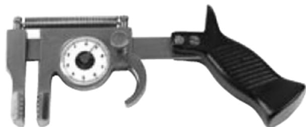
Cutimètre revolver à ressort
